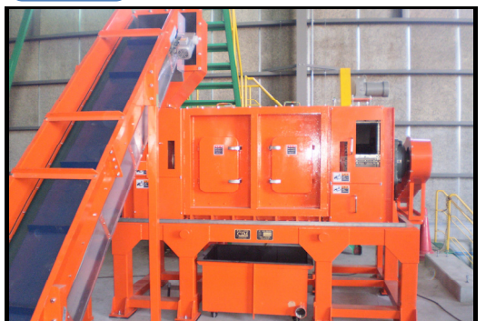
⑮ ビニール洗浄脱水機
